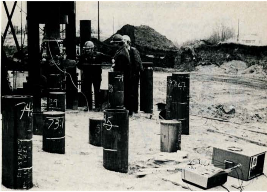
Bild 7: Kraft- und Beschleunigungsgeber zwischen einem Dieselbären und einem 12-Zoll Stahlrohrpfahl, Spezialrechner und Magnetbandgerät auf einer Baustelle zur Überprüfung der Pfahltragfähigkeiten. (Die auf den Pfählen geschriebenen Werte sind Pfahl-tiefen in Fuss).
