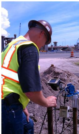
Figura 3 – Execução de um ensaio de perfilagem térmica de integridade
